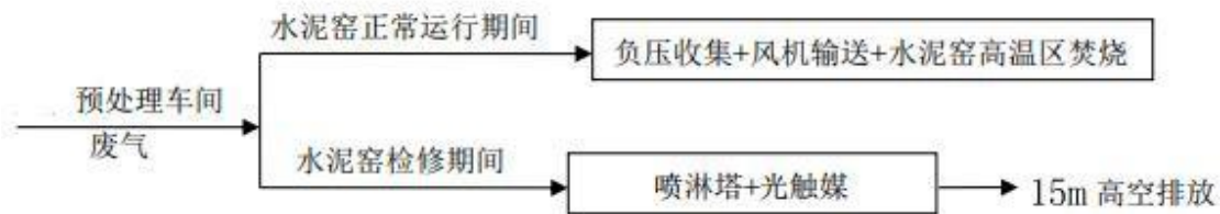
图 4.2-1 预处理车间废气处理工艺示意图
