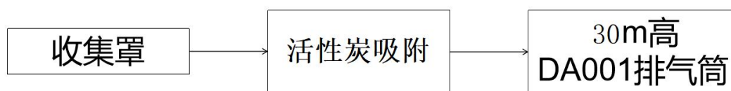
图 4.6-1 项目废气处理工艺流程图
